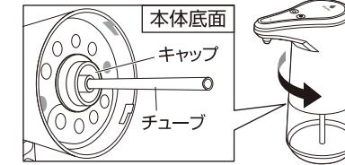
※本体を外した際、タンクのキャップが本体側(チューブ)に付く場合は、キャップを取り外してください。
